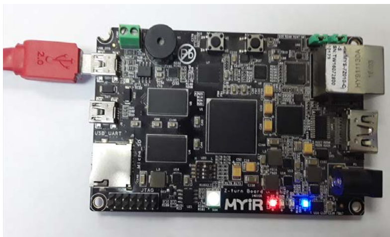
Сурет 4.3 – Xilinx Zynq XC7Z020 жүйесі орнатылған MYIR Z-turn түзету тақшасы
